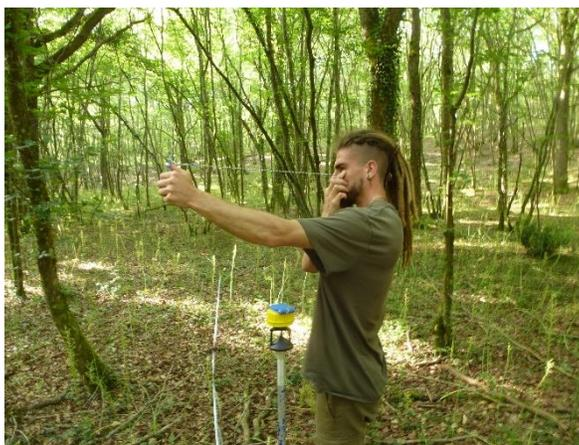
Photographie 5 : Mesure de la surface terrière avec un relascope sur le site du Patouillet (18). Photo : Serge Gressette.
